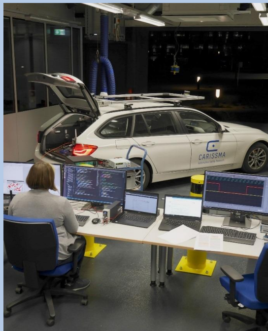
Abb. 4: Testaufbau Kopplung Car2X-Simulation mit Testfahrzeug zur Zuverlässigkeitsbewertung. (Quelle: THI)
