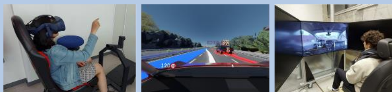
Abbildung 3: Ausschnitte der Nutzerstudien im Teilprojekt 2. Durch Fahrsimulation und Virtual Reality-Studien können neuartige Anzeigekonzepte für das automatisierte Fahren beispielsweise in Bezug auf die Akzeptanz, das Vertrauen und das allgemeine Nutzererlebnis untersucht werden. Quelle: THI
