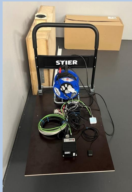
Abbildung 1: Prototyp mit Inertialsensorik und GNSS. Quelle: THI
