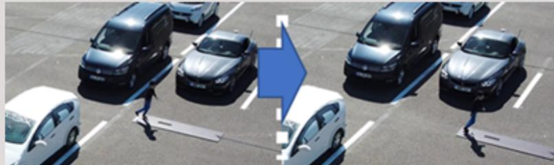
Abb. 5: Gezeigt wird die Nachbildung eines realen Verkehrsszenarios auf dem Freiversuchsgelände. Ein Fußgänger versucht, eine Straße zu überqueren, und ein Fahrzeug führt eine Vollbremsung durch, um einen Zusammenstoß zu vermeiden. (Quelle: THI)
