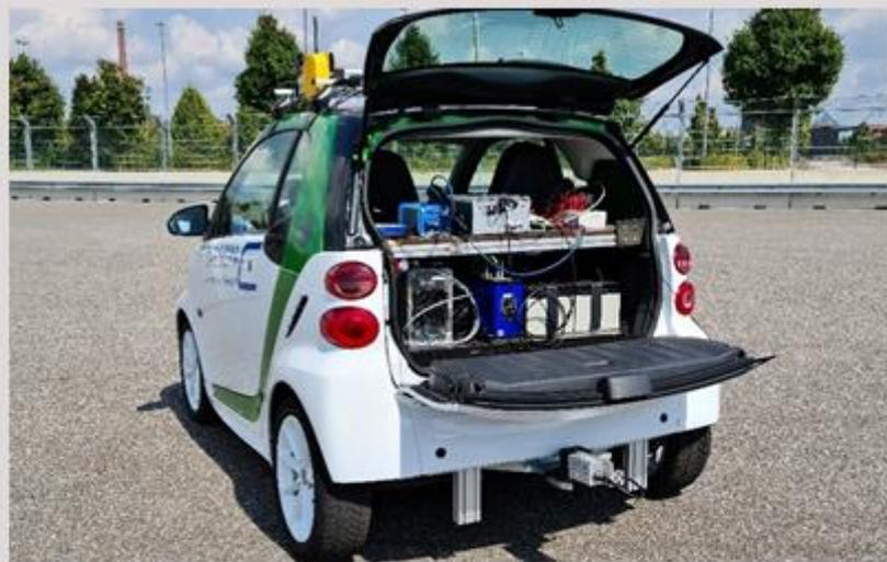
Abb. 1: Abgebildet ist ein Testfahrzeug, das mit einem ADMA G-Pro+, einem Correvit S-Motion und einem Car-PC ausgestattet ist. (Quelle: THI)
