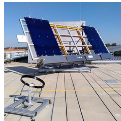
Abbildung 5: Isolierglaskollektor-Prototypen auf dem Prüfstand in den Laboren der THI
