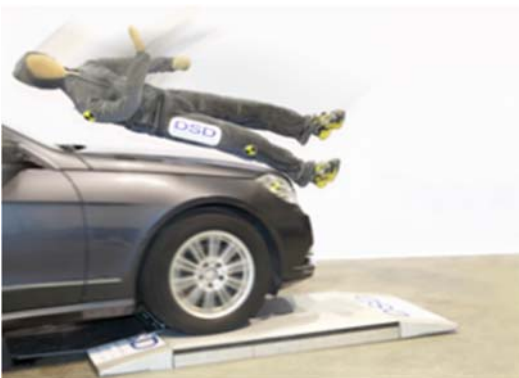
CARISSMA Fußgängertarget (Version mit Freiheitsgrad 10)
