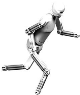
CARISSMA Fußgängertarget (Version mit Freiheitsgrad 10)
