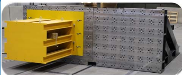
Demontierbarer Crashblock mit Offset-Barriere (Träger für ODB-Block)
