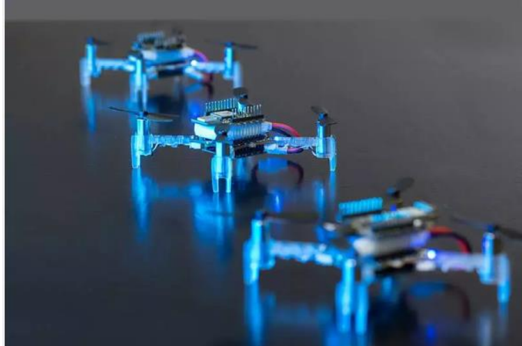
Figure 1: Crazyflie 2.1 Mini Quadcopter
